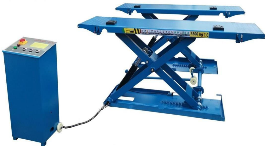
2.1-сурет – Автосервиске арналған қайыш типтес көтергіш құрылғы
